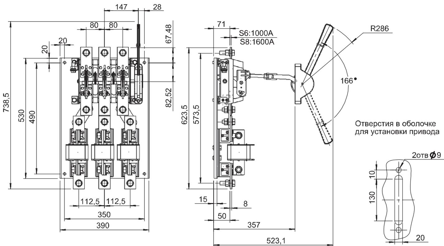
Рис. 2. Разъединители-предохранители с передней смещенной рукояткой на токи 1000 А и 1600 А масса, не более: РПС-10 – 26,35 кг; РПС-16 – 29,3 кг
